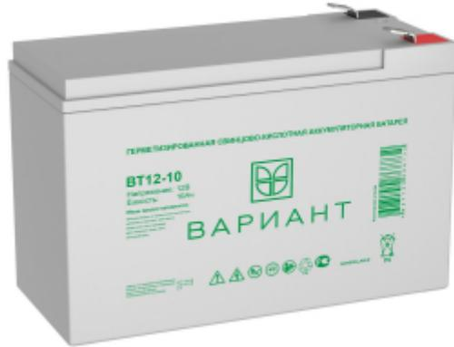
ВАРИАНТ серии BT12-10 - герметизированные, выполненные по технологии AGM, свинцово-кислотные аккумуляторные батареи общего применения со сроком службы до 8 лет в буферном режиме или более 260 циклов заряд-разряда в циклическом режиме при 100% разряде. Эти высокоэффективные перезаряжаемые батареи не требуют обслуживания в течении всего срока службы.
