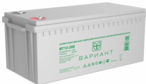
ВАРИАНТ серии ВТ12-200 - герметизированные, выполненные по технологии AGM, свинцово-кислотные аккумуляторные батареи общего применения со сроком службы до 12 лет в буферном режиме или более 260 циклов заряд-разряда в циклическом режиме при 100% разряде. Эти высокоэффективные перезаряжаемые батареи не требуют обслуживания в течении всего срока службы.
